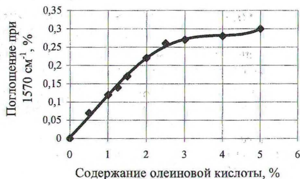
Рисунок. Зависимость поглощения растительного масла на частоте 1570 см -1 от содержания в нем олеиновой кислоты
