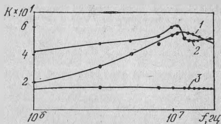
Рис. 4. Зависимость фактора потерь полиэфирного лака от частоты электрического поля и агрегатного состояния.
