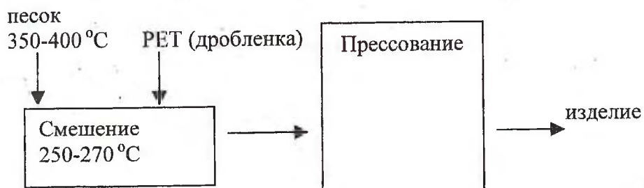
Рис. Технологическая схема получения изделий из термопласткомпозиатов
