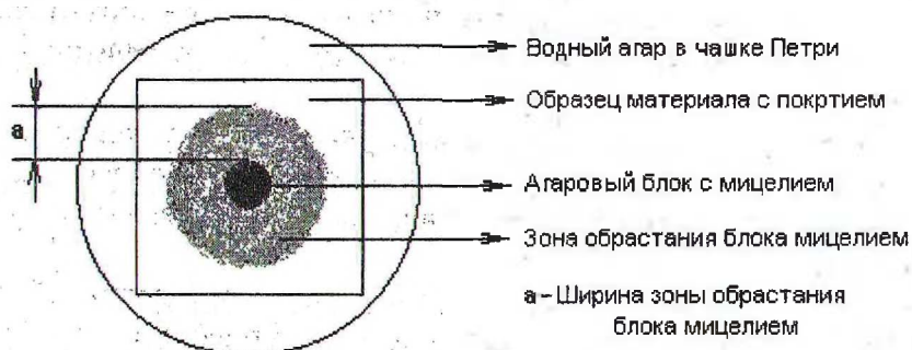
Рис. Схема проведения испытаний по экспресс-методу оценки грибостойкости материалов (покрытий)
