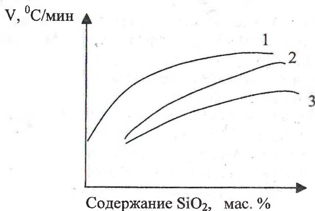
Рис. 1. Зависимость скорости подъема температуры от содержания SiO 2 в ПАК при формировании пленок различной толщины: 1 – пленка толщиной 30 мкм; 2 – пленка толщиной 40 мкм; 3 – пленка толщиной 60 мкм
