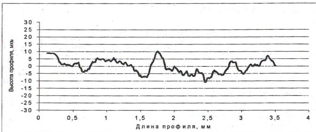
Рис. 2. Профилограмма для ВПВВ, обработанного моносульфитом натрия с расходом 3%
