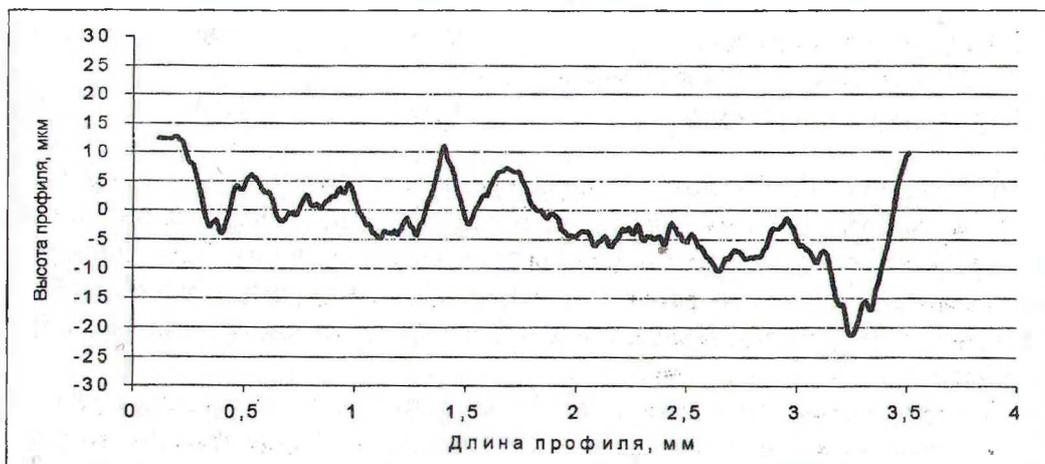
Рис. 3. Профилограмма для ВПВВ, обработанного карбамидом с расходом 3%
