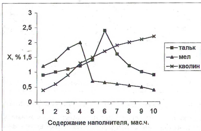
Рис. 2. Влияние содержания наполнителя на водопоглощение вспененного СЭВА
