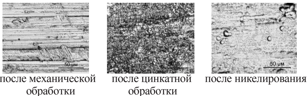
Рисунок 2 – Изменение профиля поверхности на разных этапах обработки
