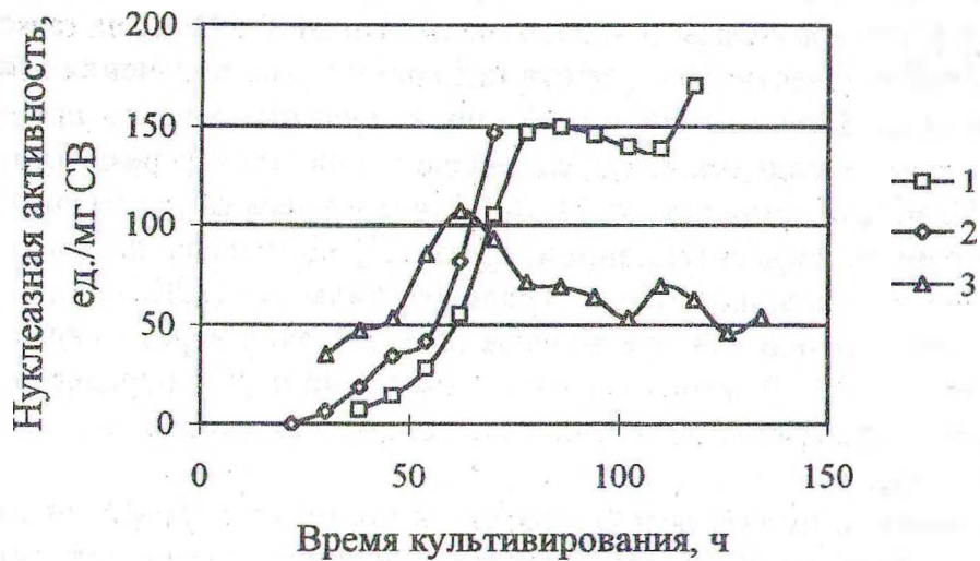
Рис. 1. Динамика накопления нуклеаз в процессе промышленного культивирования штаммов-продуцентов гидролитических ферментов: 1 - культура Asp. awamori , процесс биосинтеза глюкоамилазы; 2 - культура Asp. awamori , процесс биосинтеза ксиланазы; 3 - культура Trichoderma reesei , процесс биосинтеза целлюлазы
