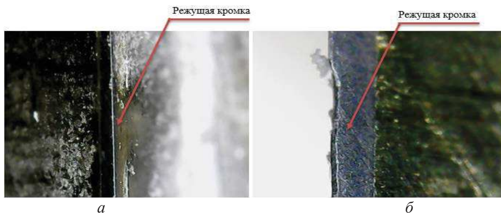
Рис. 5. Микрогеометрия режущей кромки: а – острое лезвие; б – лезвие, потерявшее режущую способность
