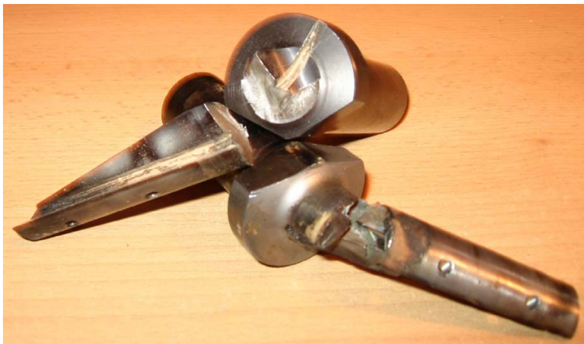
Рисунок 1 – Усталостное разрушение тела концевой фрезы
