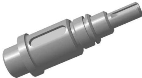
**Рисунок – Вал редуктора выходной**
