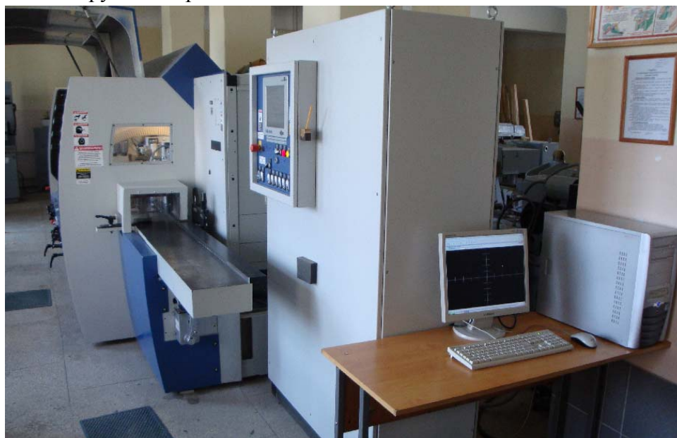
Рисунок 1 – Экспериментальная установка на базе четырехстороннего продольно-фрезерного станка Unimat 23 EL
