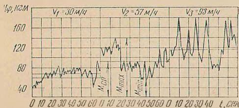
Рис. 4. График изменения нагрузки на фрезе КФН-1200 с гидромеханической трансмиссией.
