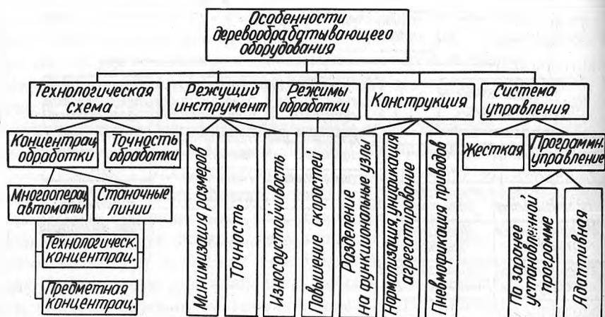
Схема 3. Основные особенности технологического д/о оборудования, обеспечивающего повышение полезного использования древесины
