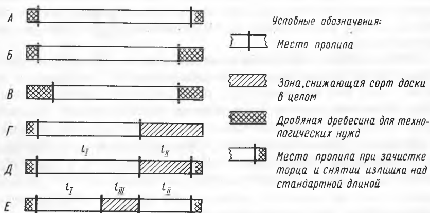
Рис. 1. Схемы раскроя обрезных досок при торцовке.
