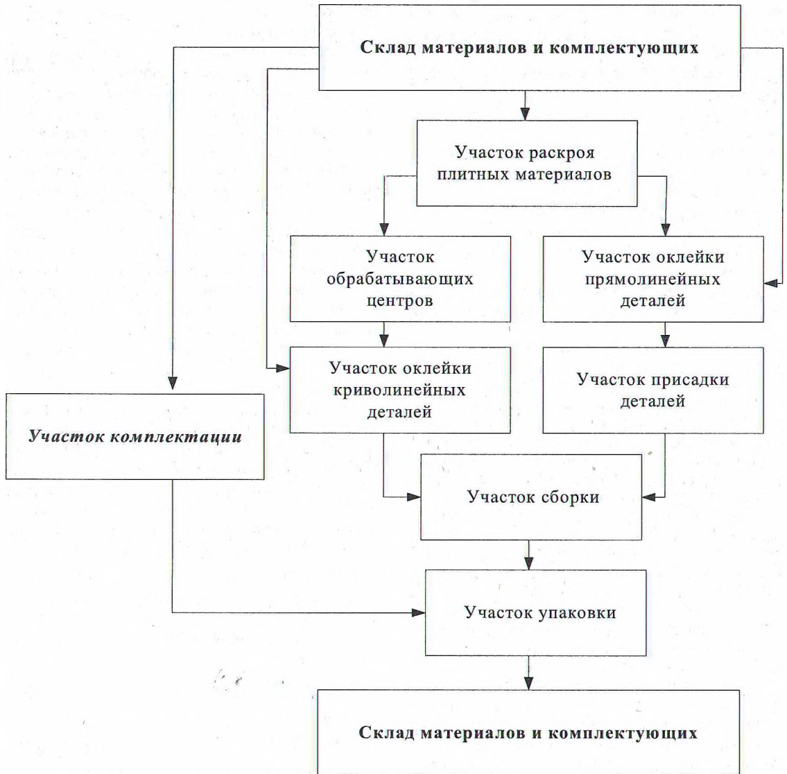
Рисунок 1 – Технологическая схема производства готовой продукции мебельного предприятия
