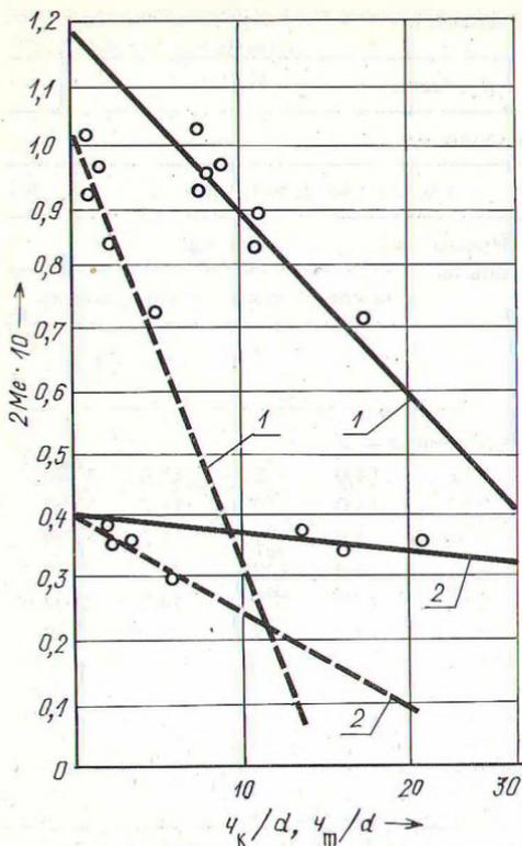
Рис. 1. Связь между безразмерными значениями коэффициентов демпфирования и отношения радиусов инерции к клиренсу моделей машин: 1 — модель сплочной машины ЛР-124; 2 — модель сплочной машины БТИ-2В; штриховые линии — для  $\chi_k/d$ ; сплошные — для  $\chi_m/d$ .
