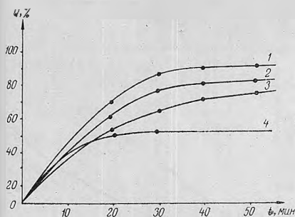
Рис. 2. Влияние давления на пропитку образцов древесины 15 \times 15 \times 22,5 мм (1—3) и 35 \times 75 \times 300 мм (4). Давление: 1, 4—8 атм.; 2—6 атм.; 3—4 атм.; Q — количество поглощенного мономера в процентах от абсолютно сухой древесины, t — время пропитки.
