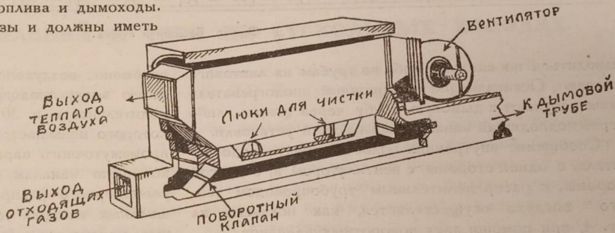
Фиг. 4. Секционный воздухоподогреватель „ABAS“.
