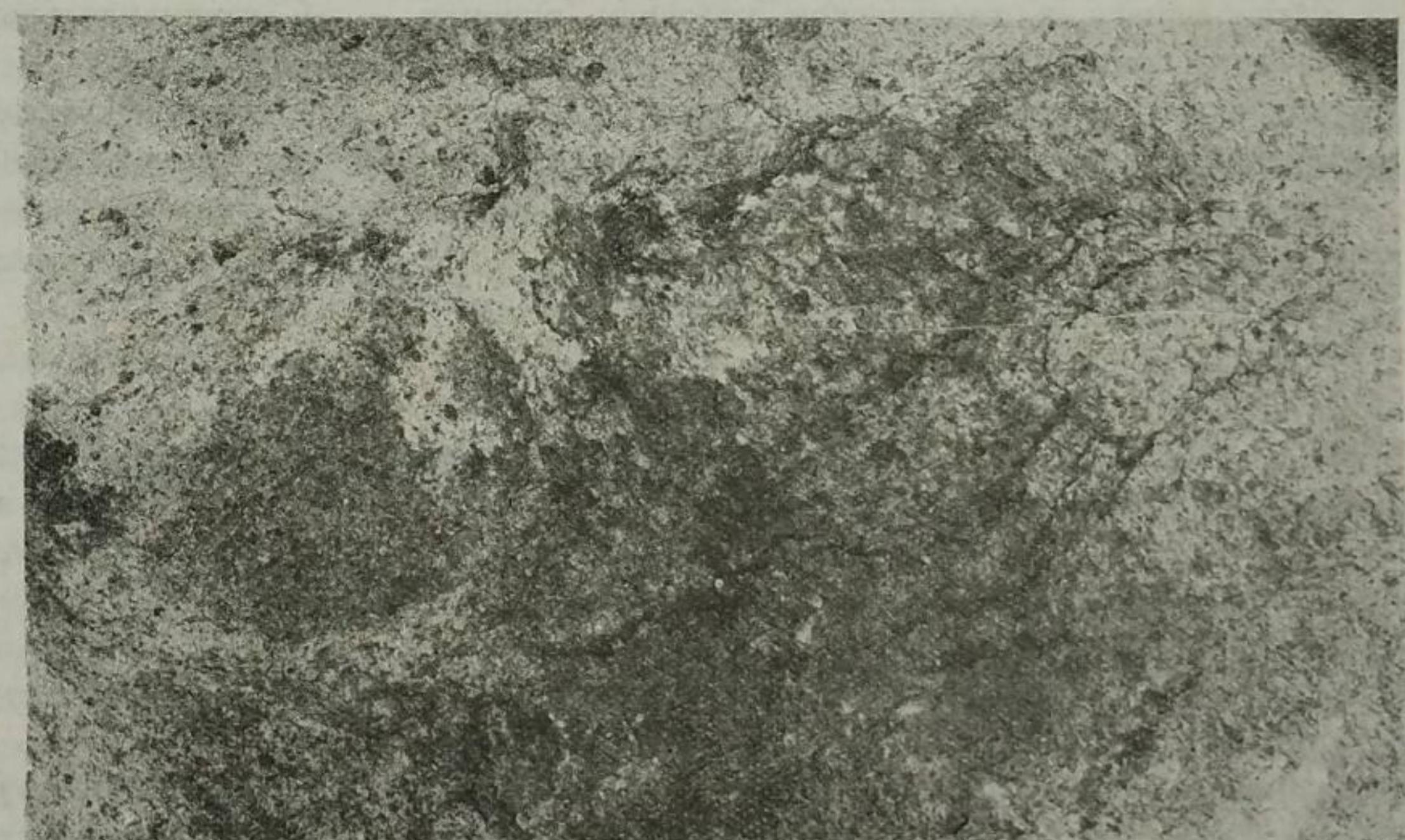
5) Должна быть равномерная зернистость в изломе, что укажет на тщательное перемешивание сырого состава (сырец, шамот) и глиняного теста перед формовкой из него припаса.
