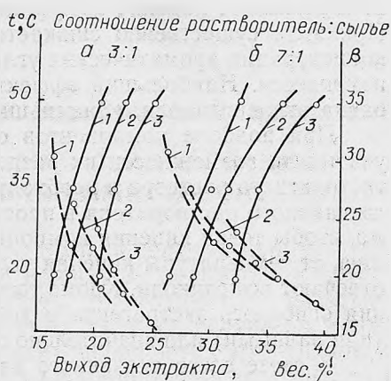
Рис. 2. Оценка избирательности разделения при различных температурах: 1 — ДМСО+ЭГ; 2 — ДМСО+ДЭГ; 3 — ДМСО + ТЭГ. — температура, °С; — коэффициент избирательности.
