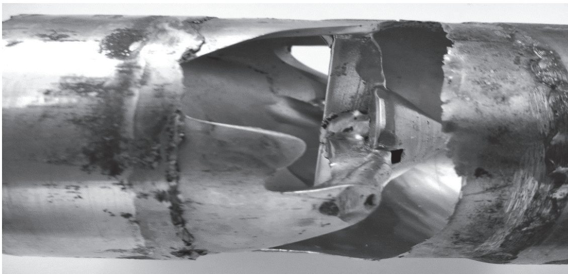
Рисунок 1 – Последствия кавитационного разрушения при неправильном проектировании суперкавитирующего аппарата
