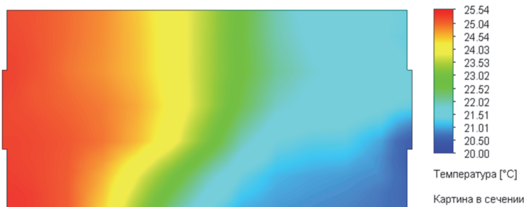
Рисунок 5 – Картина в сечении по температуре при \omega_6 = 50 \text{ с}^{-1}
