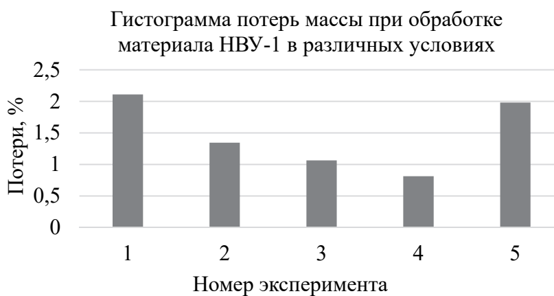
Рисунок 2 – Зависимость потери массы углеродного материала от силы тока
