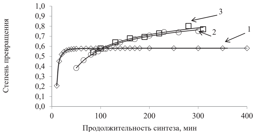
Рисунок 2 – Динамика синтеза ВТП при 75 °С в ДМСО (1), ДМАА (2) и ДМФ (3) при содержании ДАК 0,263 % (от массы РС)
