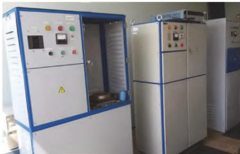
Рисунок 1 — Магнитно-импульсные установки, изготовленные в ФТИ НАН Беларуси
