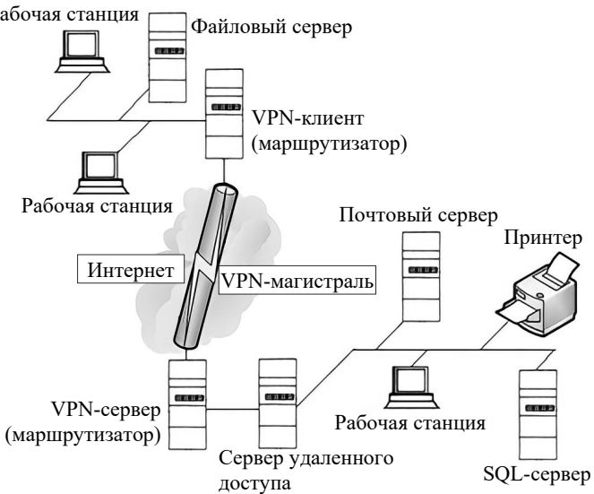
Рис. 10.18. Схема VPN-соединения между маршрутизаторами
