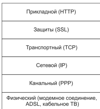
Рис. 13.2. Расположение SSL в структуре обычного стека протоколов
