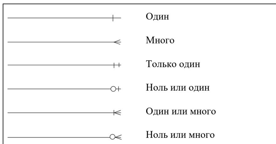
Рис. 2.3. Условные обозначения типов связей между таблицами
