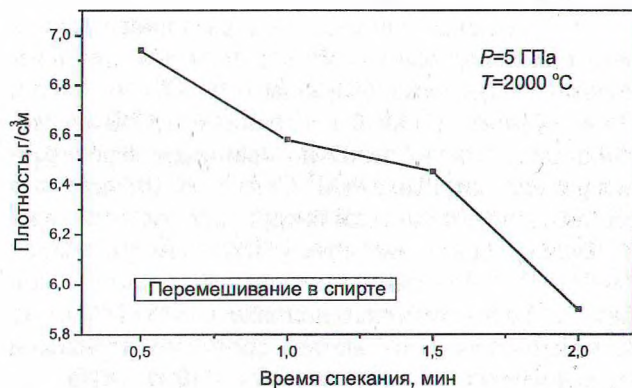
Рис. 3. Зависимость плотности композитов C_p – 90 мас.% Ni от времени спекания
