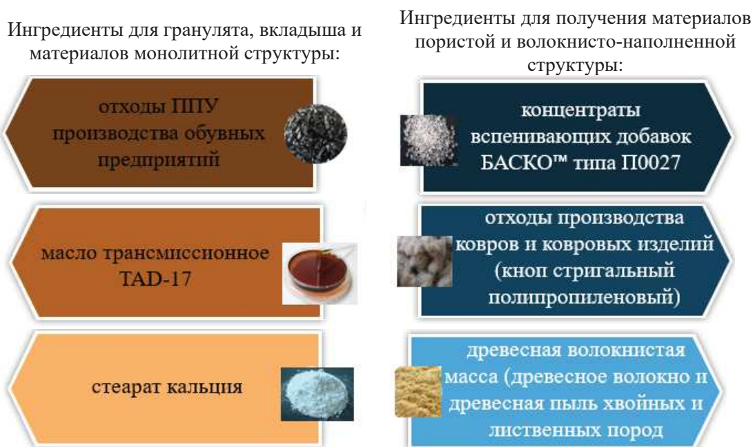
Рис. 1 Основные компоненты литьевой композиции
