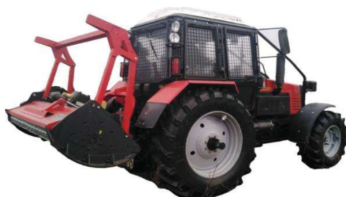
Рис. 4 - «БЕЛАРУС» МУЛ-1221 с мульчерным оборудованием
