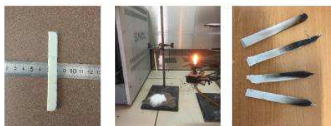
Определение стойкости к горению ПЭТФ образцов
