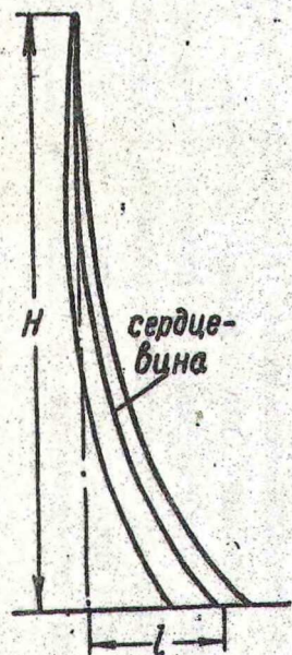
Рис. 1. Схема определения величины искривления ствола
