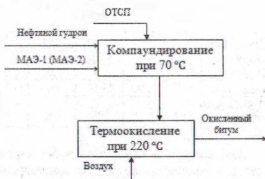
Рис. 1. Схема получения окисленного битума Fig. 1. Scheme for obtaining oxidized bitumen
