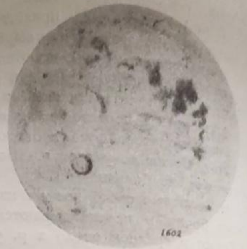
Рис. 3. Посторонние включения в фарфоровой глазури.
