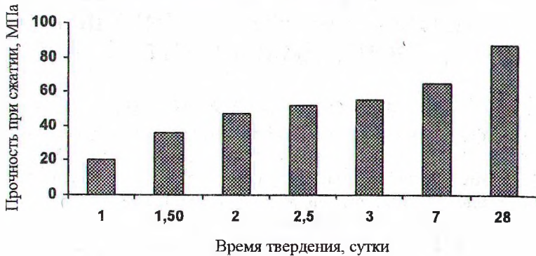
Рис. 3. Зависимость прочности при сжатии магнезиального цемента из доломита от времени твердения.
