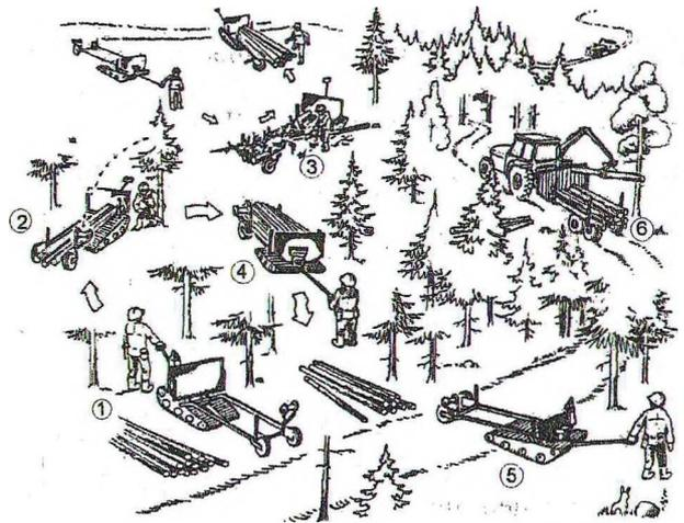
Рис. 4. Схема заготовки сортиментов на рубках ухода в комплексе с погрузочно-транспортной машиной
