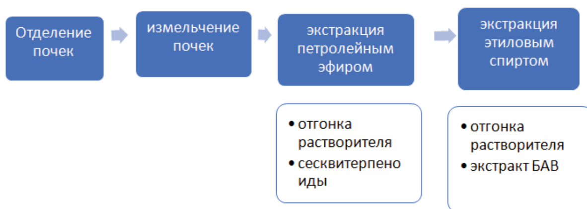
Рисунок 2 – Принципиальная схема производства спиртового экстракта
