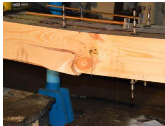
Рис. 8. Разрушение клееной шпалы
