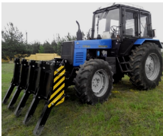
Рис. 1. Машина для сбора лесосечных отходов
