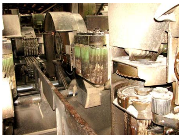
Рис. 2. Фрезерно-пильный станок VPS
