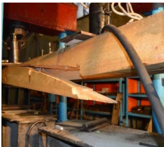
Рис. 7. Разрушение составной шпалы
