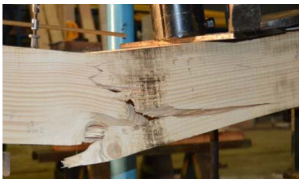
Рис. 6. Разрушение цельной шпалы
