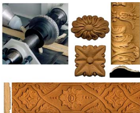
Рис. 7. Декоры, получаемые с использованием древесной пульпы
