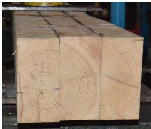
Рис. 1. Комбинированная клееная шпала
