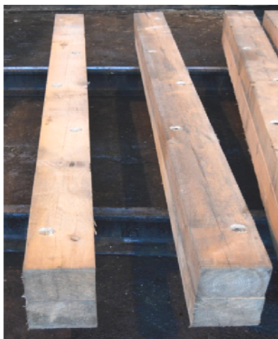
Рис. 2. Комбинированная сборная шпала
