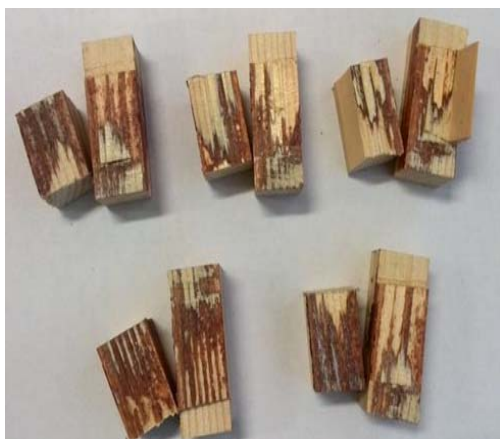
Рис. 10. Характер разрушения образцов
