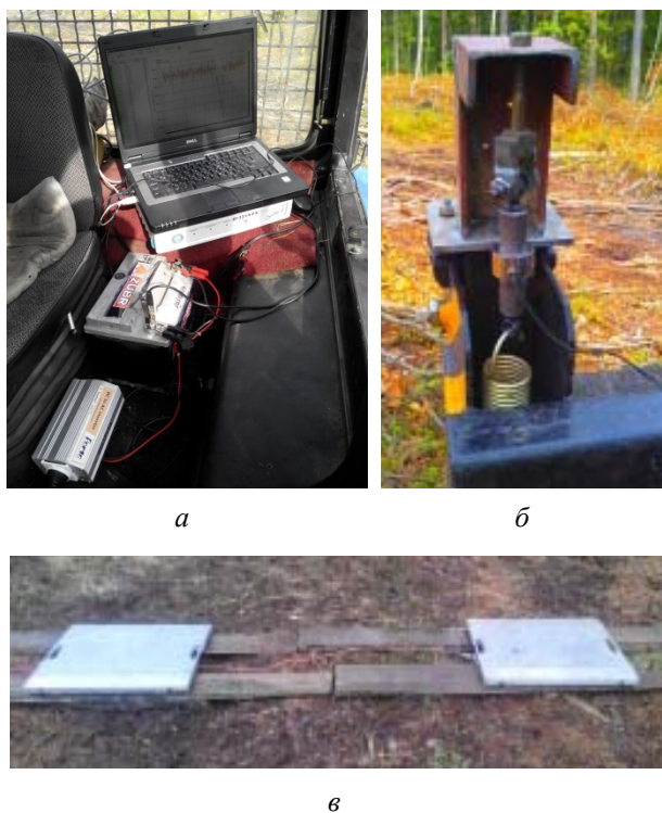
Рис. 3. Измерительное оборудование: а – многофункциональное измерительное оборудование Spider 8, переносной персональный компьютер с аккумулятором и адаптером; б – датчик силы U9B; в – устройство деформации УД-1
