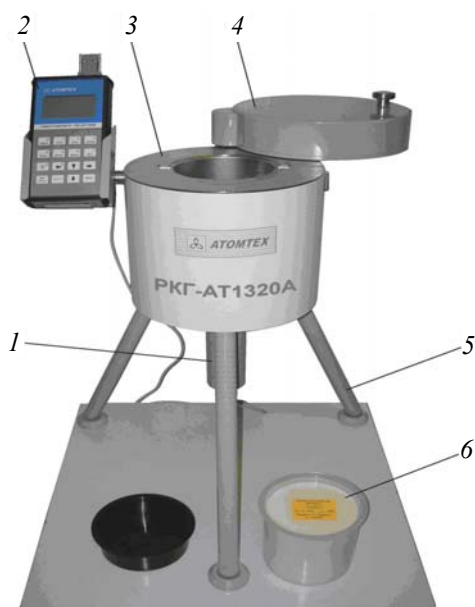
Рис. 2. Гамма-радиометр РКГ-АТ1320А: 1 – блок детектирования; 2 – блок обработки информации с ЖКИ; 3 – блок защиты; 4 – крышка блока защиты; 5 – ножки; 6 – измерительный сосуд
