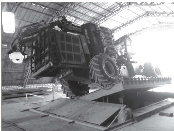
Рис. 4. Стенд для определения предельного угла поперечной устойчивости СУ-40
