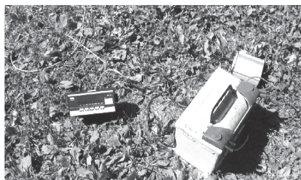
Рис. 6. Оборудование для определения усилия сопротивления движению и тяги мобильной рубильной машины
