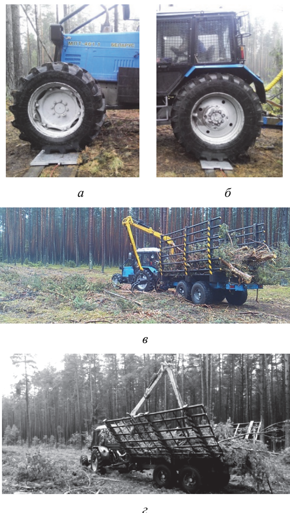
Рис. 4. Определение реакций под колесами машины для транспортировки лесосечных отходов: а – определение реакции под передней осью базового трактора; б – определение реакции под задней осью базового трактора; в – погрузка лесосечных отходов с закрытыми бортами; г – погрузка лесосечных отходов с открытыми бортами
