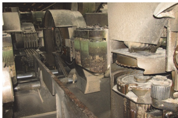
Рис. 4. Расположение рабочих органов фрезерно-пильного станка VPS22
