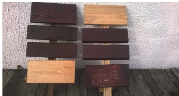
Рис. 2. Натурные испытания масляных покрытий
