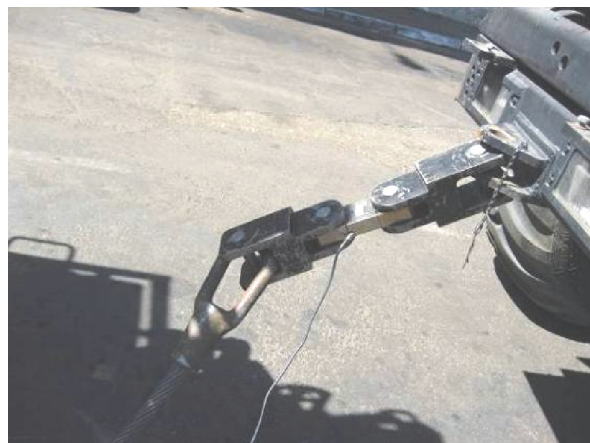
Рис. 7. Тензометрический датчик электронного динамометра ДОР-3-И-200
