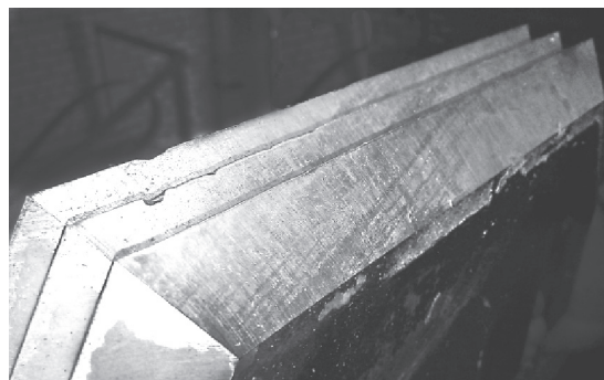
Рис. 5. Фото комплекта ножей фрезы левого исполнения фрезерно-брусующего станка после 48 ч работы
