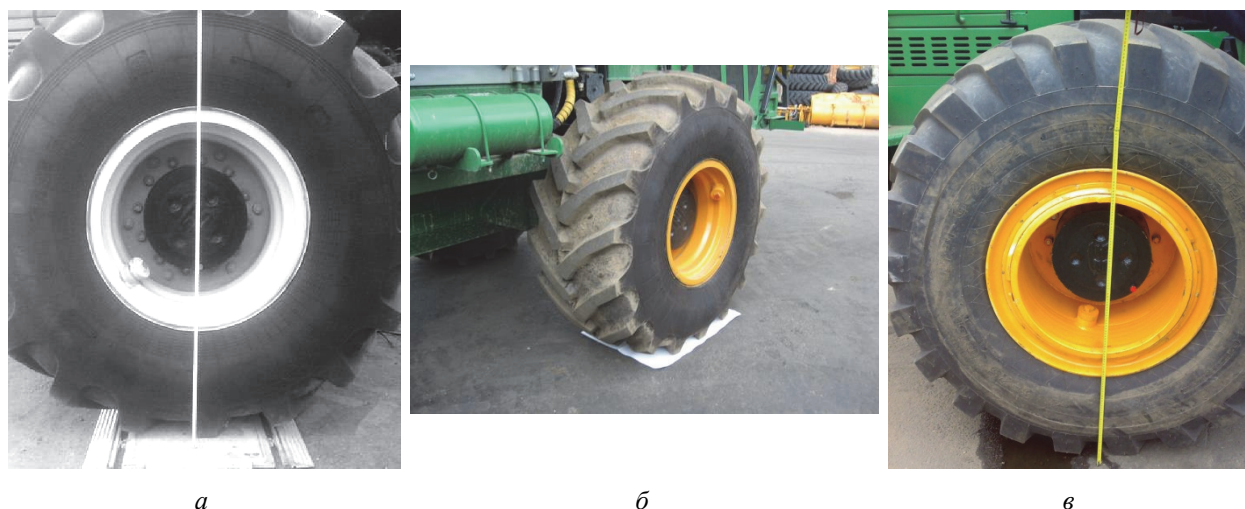
Рис. 1. Определение параметров ходовой части мобильной рубильной машины:
