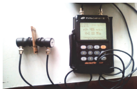
Рис. 2. Измеритель времени и скорости распространения ультразвука «Пульсар-2»
