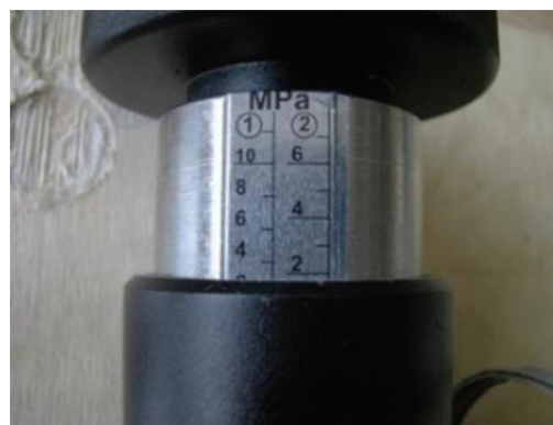
Рис. 3. Адгезиметр «Константа АЦ»: а – общий вид прибора; б – детали; в – шкала
