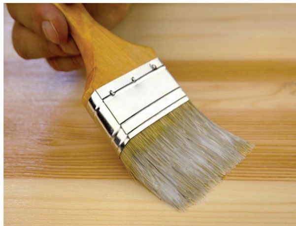
Рис. 1. Нанесение лакокрасочного состава на образцы кистью
