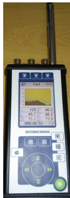
Рис. 3. Общий вид прибора ЭКОФИЗИКА 110А с программным обеспечением
