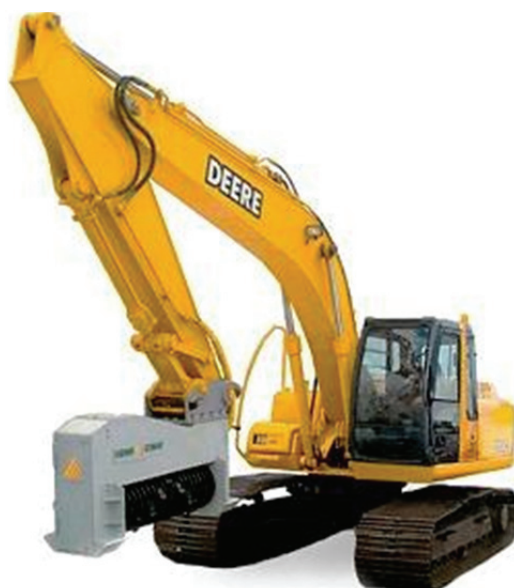
Рис. 2. Одноковшовый гидравлический экскаватор со сменным рабочим органом «мульчер»
