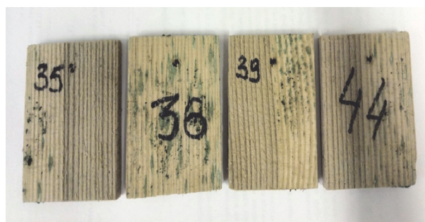
Рис. 3. Образцы после искусственного старения, срок эксплуатации – 1 год
