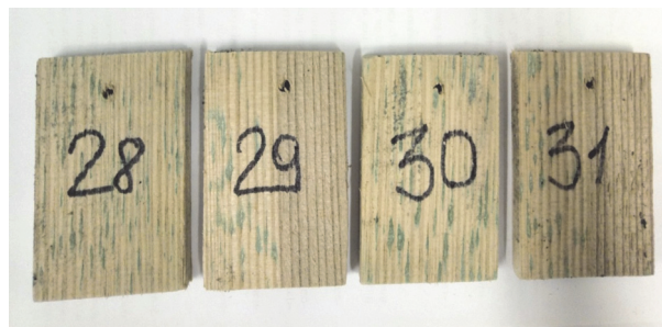
Рис. 2. Образцы после искусственного старения, срок эксплуатации – 6 месяцев
