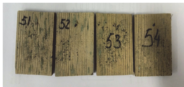
Рис. 4. Образцы после искусственного старения, срок эксплуатации – 2 года
