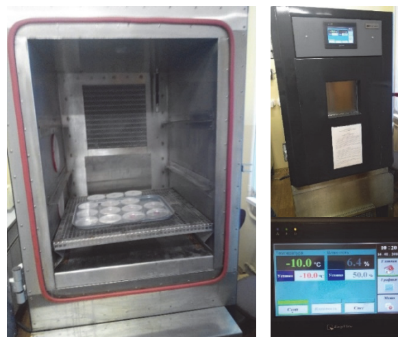
Рис. 6. Лабораторная климатическая камера «Термоконт ТХВ-225»
