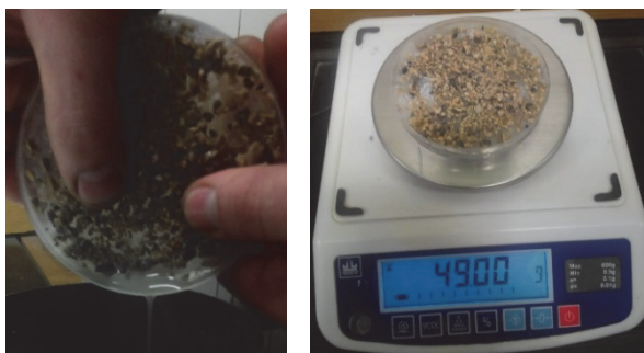
Рис. 5. Слив образовавшейся суспензии и взвешивание остатков
