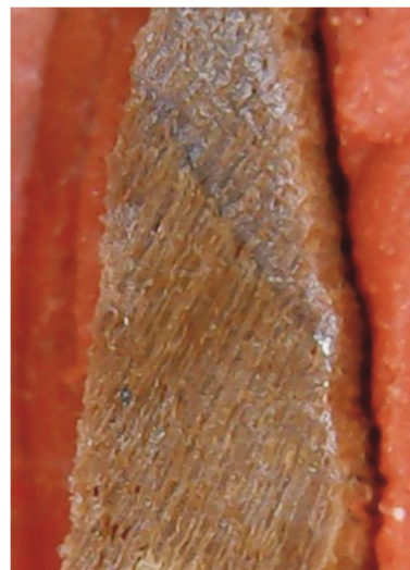
Рис. 4. Образец уплотненной древесины ольхи
