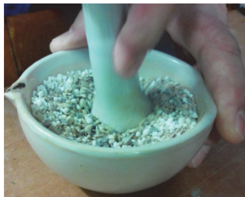
Рис. 2. Приготовление химико-фрикционного противогололедного материала
