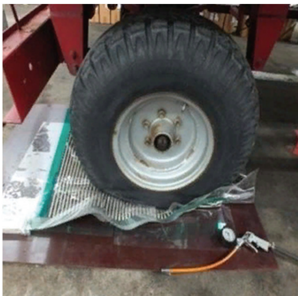
Рис. 3. Сетчатый датчик для определения параметров зоны контакта колеса с опорной поверхностью
