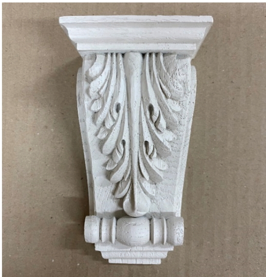
Рис. 3. Фрагмент декора мебели, напечатанный на 3D-принтере по технологии FDM
