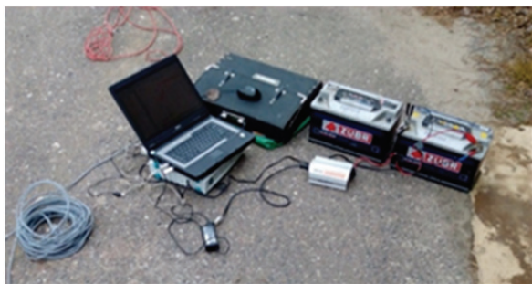
Рис. 6. Измерительное оборудование в составе многофункционального измерительного усилителя Spider 8 и портативного ПК
