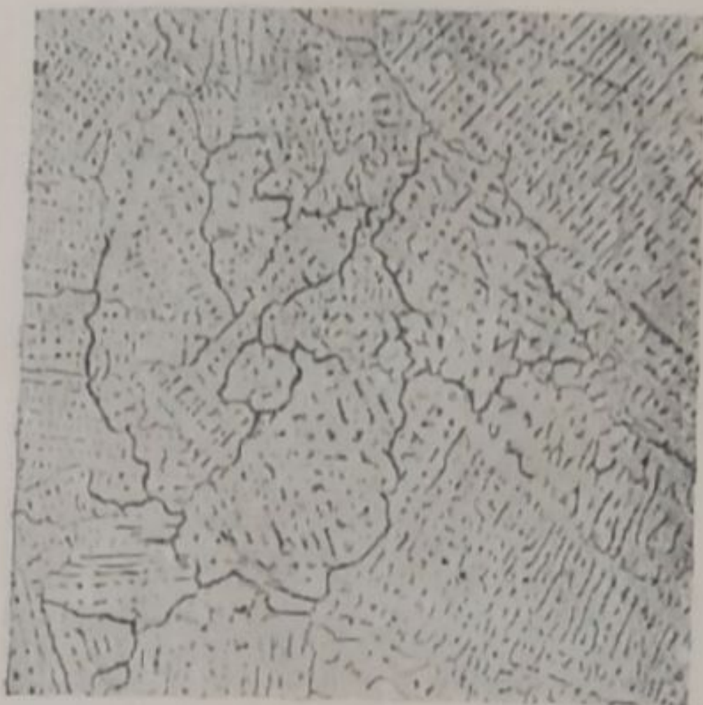
Рис. 26. \times 114 ; литой, 8.85% Mn и 1.45% С.
