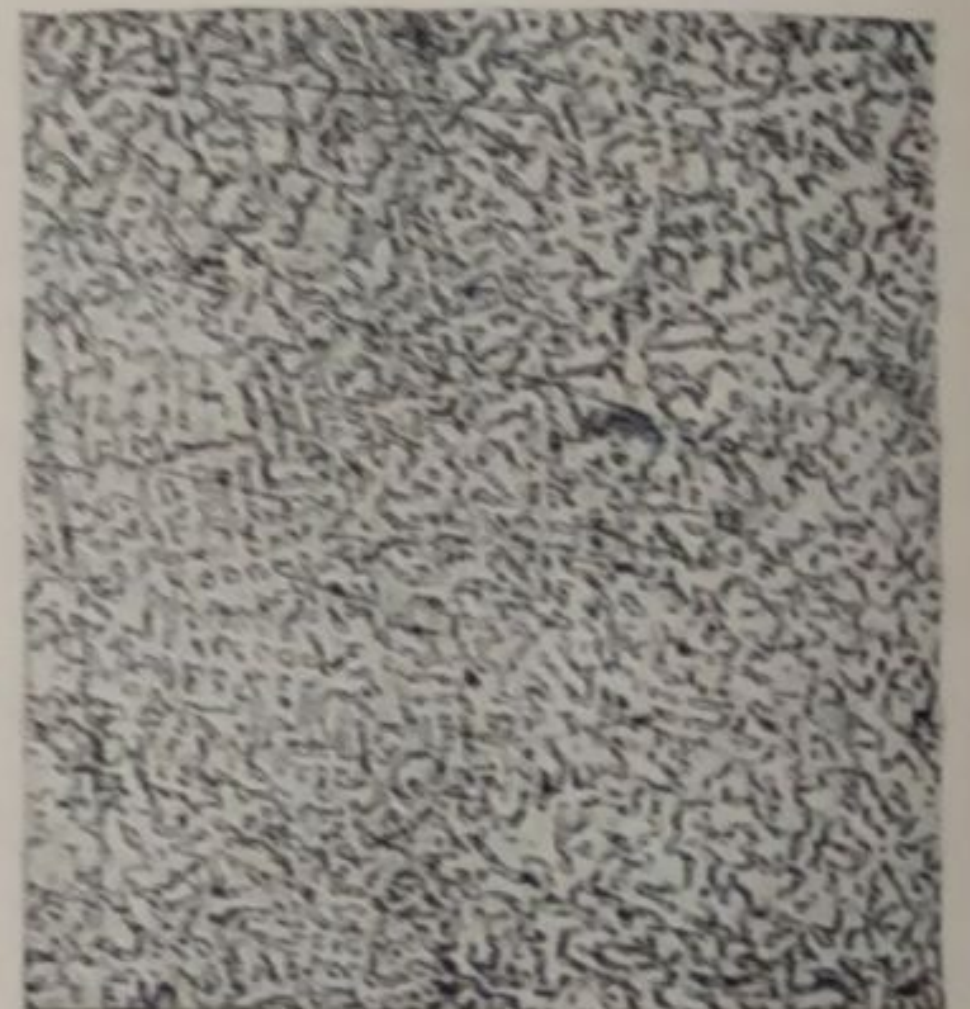
Рис. 33. \times 114 ; отожженный, 32.90% Mn и 1.40% С.
