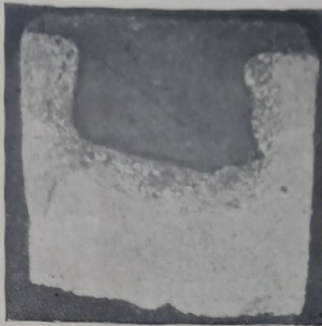
Рис. 1. Разрушение шамотного кирпича после нагревания при 1200^{\circ} в течение 2 час.
