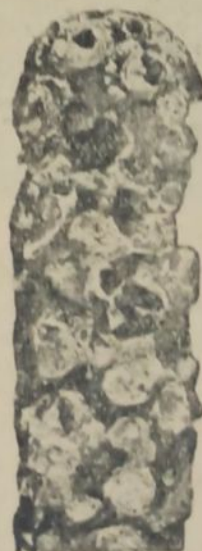
Рис. 7. Изолированная, утолщенная пленка с поверхности железа, копирующая форму образца.
