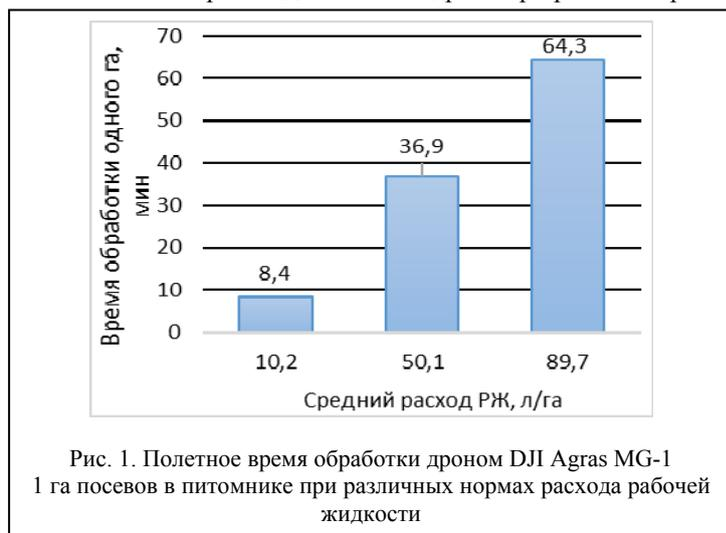
Рис. 1. Полетное время обработки дронам DJI Agras MG-1 1 га посевов в питомнике при различных нормах расхода рабочей жидкости
