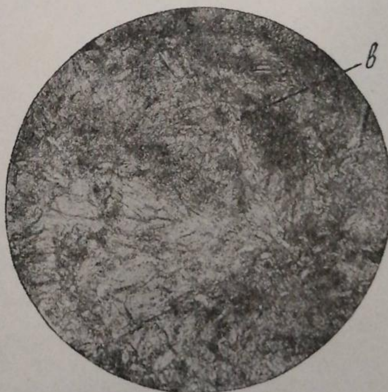
Рис. 5. Стекло, содержащее \text{SiO}_2 51,73\% , CaO 48,27\% , было нагрето в течение 600 час. при 1100^{\circ} и раскристаллизовано до состояния чистого воластонита, лишенного каких-либо включений.
