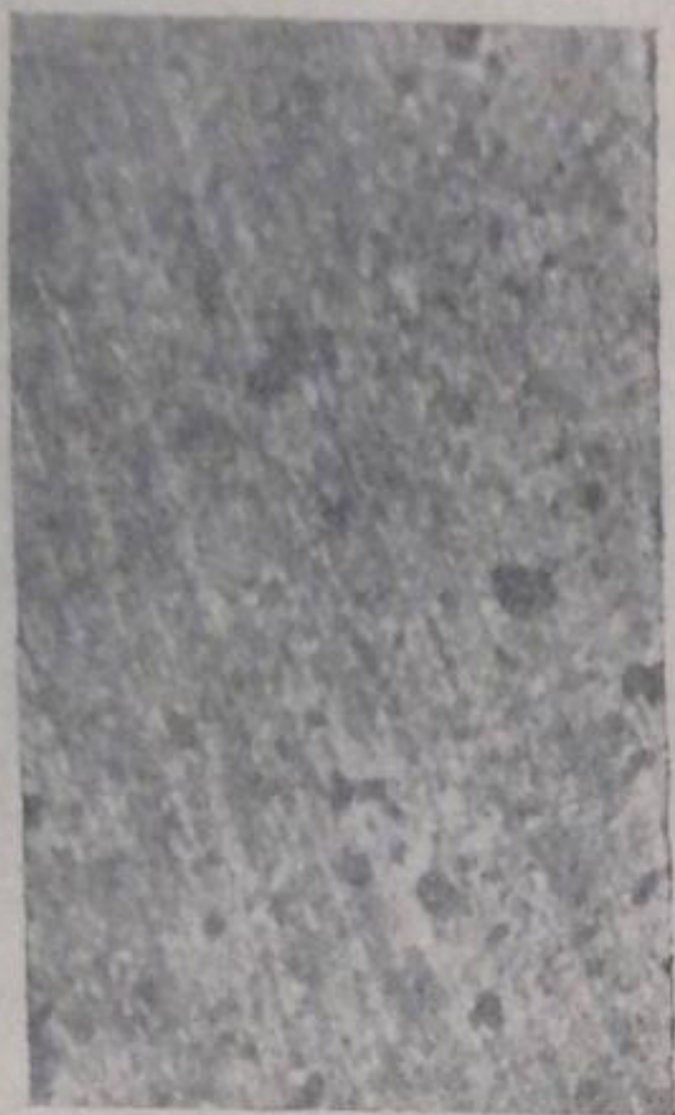
Рис. 6. Сплав с содержанием 15% Cr и 9% Al. \times 5 .
