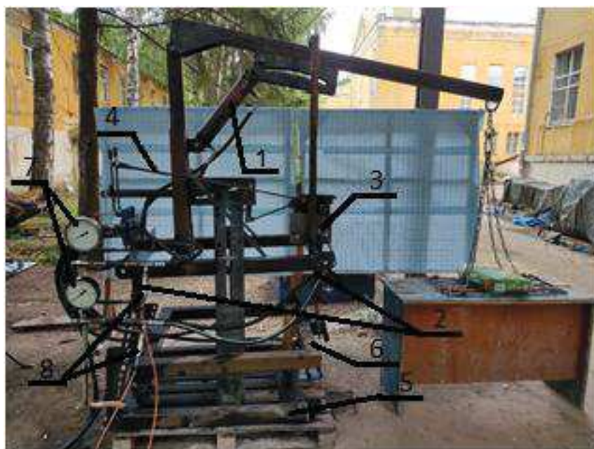
1 – гидроцилиндр стрелы, 2 – гидроцилиндры аутригеров, 3 – противовес, 4 – тяга выравнителя, 5 – неподвижная рама, 6 – подвижная рама, 7 – манометры, 8 – датчики давления
