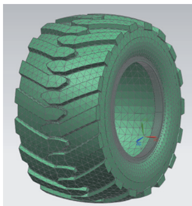
Рис. 3. Конечно-элементная модель пневматического колеса в NX Siemens
